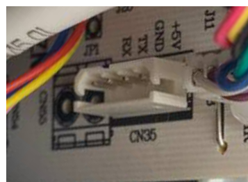
Изображение 2. Примеры разъемов на плате кондиционера.
