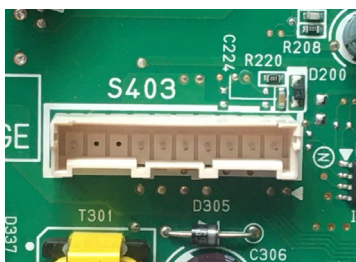
Изображение 2. Примеры разъемов на плате кондиционера.
